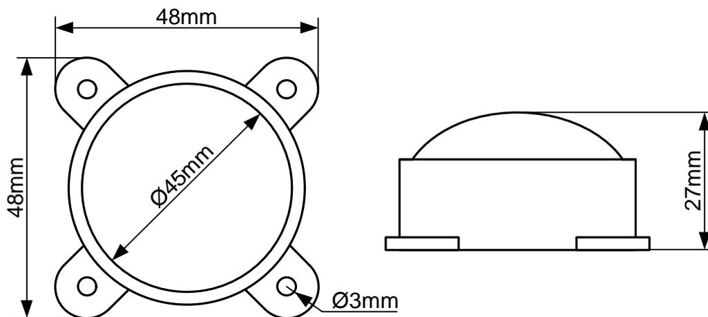
Данные пиксели устанавливаются на плоскости через уши или в отверстие  $\varnothing 45$  мм.
